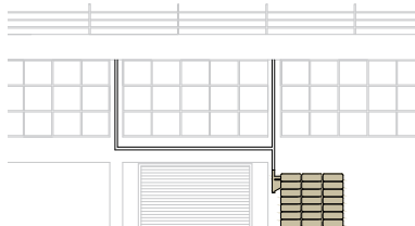
DETALHE GÊNÉRICO DA INSTALAÇÃO DA CISTERNA DA GARAGEM
